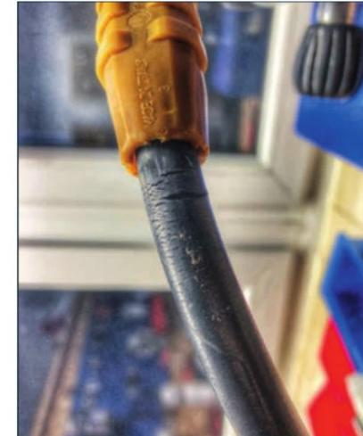
Schläuche kann man selbst regelmäßig prüfen. Hat man einen Knickschutz über dem Schlauch, sollte man trotzdem den Schlauch darunter überprüfen. Auch er kann porös werden. Platzende Schläuche sind nicht selten. Über Wasser können sie erschrecken, unter Wasser gefährlich werden.
