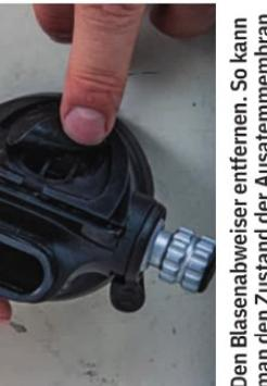
Den Blasenabweiser entfernen. So kann man den Zustand der Ausatemmembran checken und sie säubern wenn nötig.
