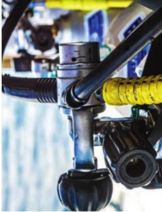
**KALTWASSER** In Wasser-Kälter als zehn Grad taucht man mit zwei getrennten ersten Stufen. Das geht mit Einzel- oder Doppelflaschen. Die Trennung von Octopus, Hauptatemregler und Tariermittel belastet die ersten Stufen weniger. Im Notfall besitzt man ein Backup-System.
