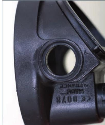
Einige Beschädigungen sind vom ungeübten Auge kaum oder gar nicht zu erkennen. Daher ist es wichtig, die Revision bei einem erfahrenen Betrieb machen zu lassen. Hier der Kunststoffrahmen einer zweiten Stufe. Auf beiden Bildern ist die identische Stufe abgebildet. Auf diesem Bild ist der feine Riss kaum zu sehen.
