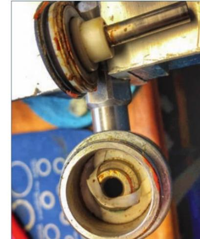
Auch bei dieser ersten Stufe wurde die Wartung erkennbar verschleppt. Sogar so, dass es zum Wassereinbruch kam. Ein Atemregler sollte nach Gebrauch stets gut durchtrocknen. Anschließend trocken und kalt lagern. Am besten hängend oder sauber zusammengerollt in einer Tasche.
