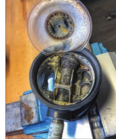
Diese zweite Stufe ist schlicht und einfach nicht ausreichend gepflegt worden. Wartungsintervalle wurden verschleppt. Dadurch erhielt die Stufe so einen Belag. Vielleicht wurde sie auch nach den Tauchgängen schlecht gelagert. Dieser Zustand ist vermeidbar, wenn man sich am Wartungsintervalle und Tips zum Atemregler-Lagerung hält.
