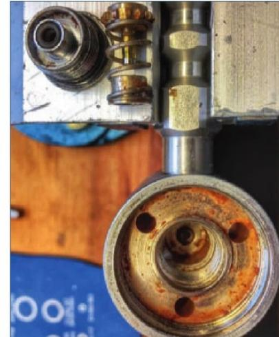
Links und rechts sind wieder identische erste Stufen abgebildet. Links vor der Wartung, rechts nach der Wartung. Der Techniker zerlegt die erste Stufe in ihre Einzelteile. Alle Gummidichtungen und Kunststoffteile werden entfernt. Die übrig gebliebenen Metallteile werden in einem Ultraschallbad mit Säure gereinigt. Bei starken Verschmutzungen mehrere Male.
