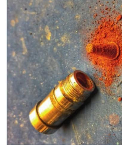
Der Sinterfilter ist ein Kupfergeflecht, das am Anfang der ersten Stufe sitzt. Meist in der Welle, die in das Flaschenventil geschraubt wird. Er wird bei jeder Revision gewechselt. Dieser Sinterfilter war nahezu vollständig dicht von Rost. Der Regler wurde sehr häufig an von innen rostigen Flaschen verwendet.
