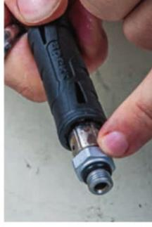
Gleiches gilt für die O-Ringe der Schläuche. Sind sie trocken, fetten. Sind sie porös, wechseln. O-Ringe gibt es im Fachhandel sofort genutzt werden.
