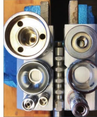
Die Hersteller stellen Revisionskits zur Verfügung. Dort sind alle auszutauschenden Teile enthalten. Der Techniker baut sie ein und setzt die Stufe zusammen. Meist benötigt man hierfür Spezialwerkzeuge. Außerdem gibt es Vorgaben, mit welchen Drehmomenten die Schrauben angezogen werden müssen.
